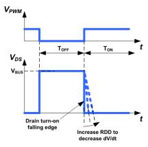
Fig. 25. Turn-on dv/dt slew rate control
